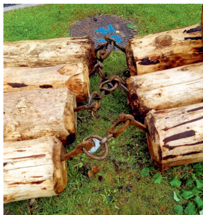
I fèr da bóre con gli anelli uniti da una girella. Quest'importante accessorio consentiva alla coàda di adattarsi nel modo migliore al fondo della strada
